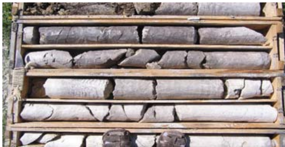
Foto: Příklad zbarvení jíků. Vrtné jádro, nejtavší horní část zbarvena organickým prachem, asi třetihorní pyl.
