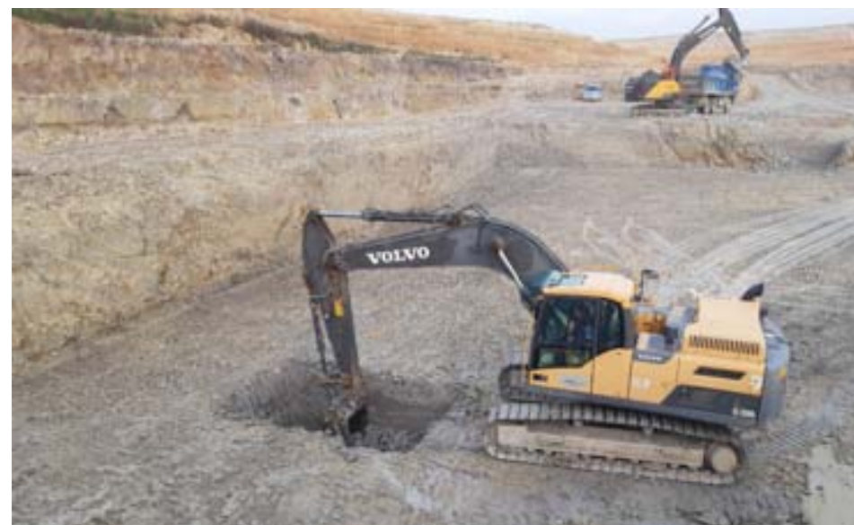
Foto: 2021 podzim, první těžba nepísčitých blautonů. Horní část vrstvy jílu B1, rypadlo blíže v jižní části ložiska s malou mocností písčitých jílu v nadloží. Ve směru k zadnímu rypadlu přibývání množství písku.
