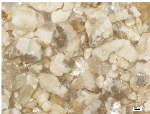
Obrázek 7. Granit Homolka, frakce 0,1-3,0 mm
