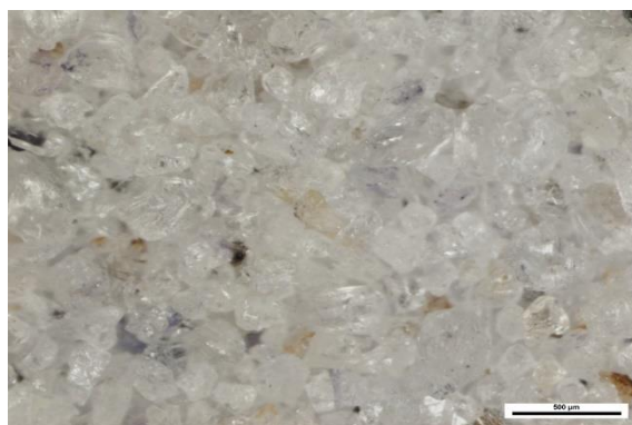
Obrázek 2. Topaz koncentrát Cínovec, TP nad 3,3 \text{ g/cm}^3 , 98 hmot.% topazu, frakce 0,1-0,5 mm
