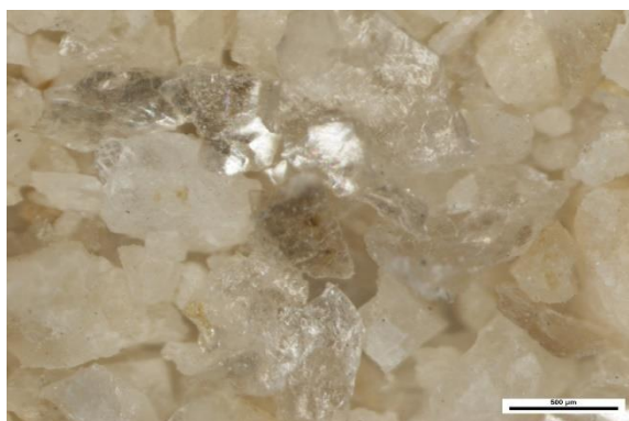
Obrázek 6. Granit Homolka, frakce 0,1-0,5 mm
