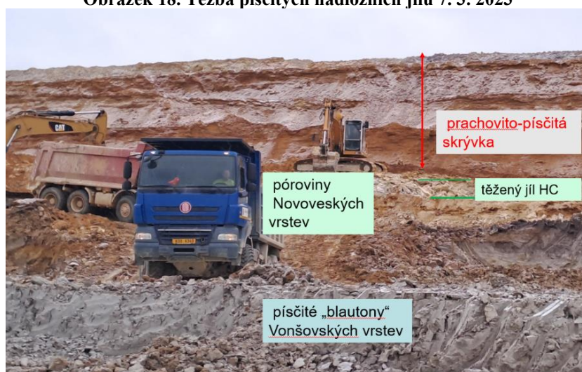
Obrázek 19. Těžba pórovinového jíilu HC z čoček v nadloží písčitých jíílů
