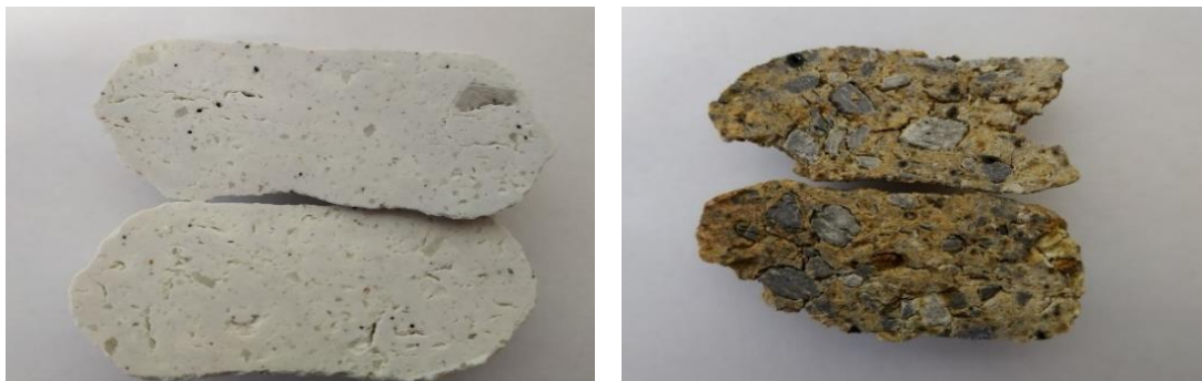
Obrázek 5. Podélné řezy briket funkčních vzorků materiálů s obsahem \text{Al}_2\text{O}_3 nad 45%
