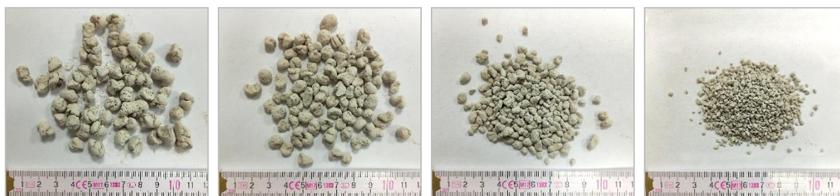
Obrázek 2. Zrnitostní frakce granulátu RON v rozsahu 10-7,1; 7,1-5,0; 5,0-2,5 a 2,5-1,25 mm.
