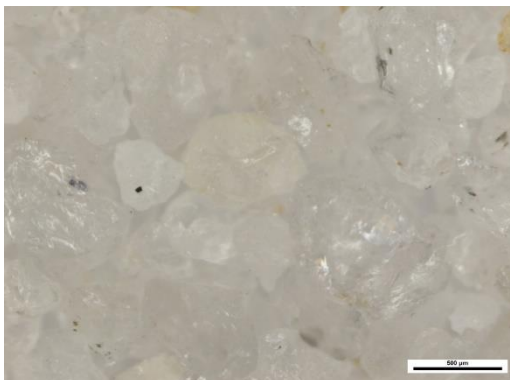
Obrázek 5. Topaz+křemen, Cínovec splav, LP, NEMAG, 11 hmot.% topazu, frakce 0,1-0,5 mm
