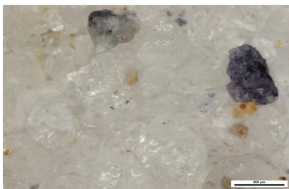
Obrázek 4. Topaz Cínovec splav TP, NEMAG, 39 hmot.% topazu, frakce 0,1-0,5 mm
