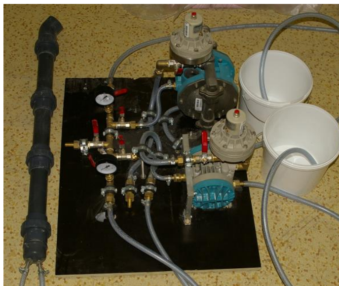
Obrázek 7. Poloprovodní pěnogenerátor vlastní výroby pro přímé napěňování keramické suspenze
