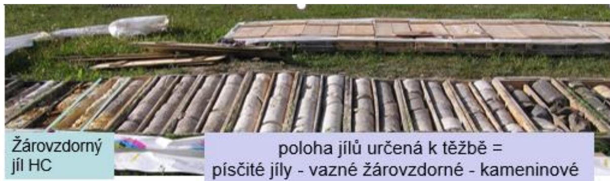
Obrázek 15. Vrtné jádro z jednoho vrtu pro vyhodnocování kvality
