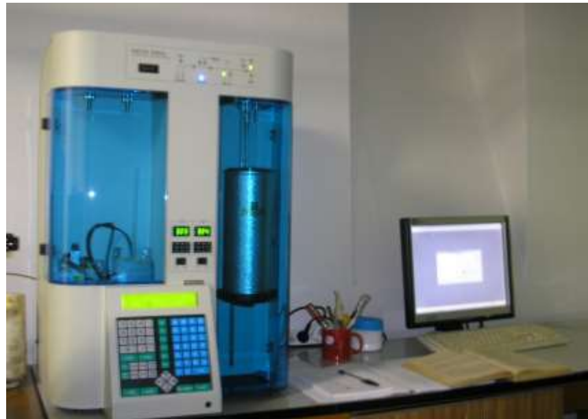
B.E.T. analyzátor Quantachrome Nova1000e
